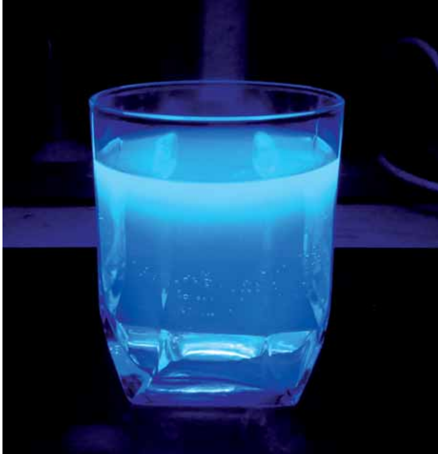
1 Раствор сульфата хинина в стакане облучается сверху ультрафиолетом (фото автора). Эта фотография иллюстрирует целых два физических закона. Во-первых, УФ-излучение поглощается раствором хинина, и интенсивность окраски уменьшается сверху вниз — это следствие закона Бугера — Ламберта — Бера. Во-вторых, если облучать стакан не сверху, а сбоку, то флуоресценции не будет, так как стекло не пропускает ультрафиолет. При этом свет, испускаемый раствором хинина, через стекло проходит. Это означает, что длина волны излученного света больше длины волны поглощенного света — закон Стокса
